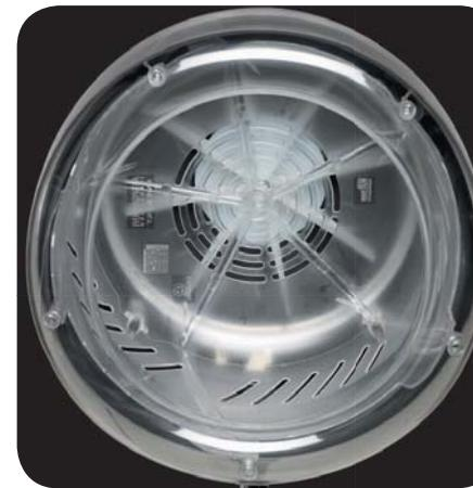
La campana di Voyager è progettata per distribuire uniformemente ed in modo semi-diretto il calore e la ventilazione. L'aria esce infatti in modo diretto dalla rete superiore, in modo indiretto dalle aperture laterali ed è parzialmente riciclata dal bordo inferiore. Il casco quindi esegue, in maniera uniforme ed ottimale, asciugature rapide, asciugature naturali senza retina e trattamenti tecnici.
