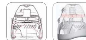
La campana di Starship è progettata per distribuire uniformemente ed in modo semi-diretto il calore e la ventilazione. L'aria esce infatti in modo diretto dalla rete superiore, in modo indiretto dalle aperture laterali ed è parzialmente riciclata dal bordo inferiore. Il casco quindi esegue, in maniera uniforme ed ottimale, asciugature rapide, asciugature naturali senza retina e trattamenti tecnici.
